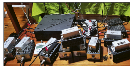
Pentaplexer und Bandpassfilter
