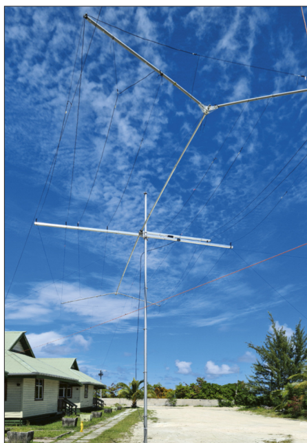
2-Element-Multiband-Beam für 20 m, 17 m, 15 m, 12 m und 10 m
