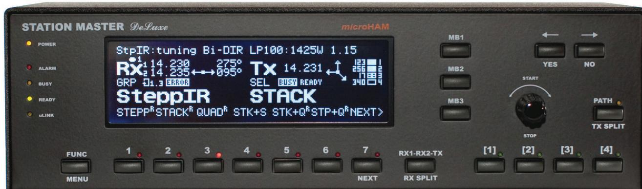
Der Station Master Deluxe™ ist der große Bruder des regulären Station Master™ und hat nicht nur alle seine Fähigkeiten übernommen, sondern bietet neben der ergonomischen Benutzeroberfläche mit einem großen 240x64 LCD Display, programmierbaren Bedienelementen auch Unterstützung für gestockte Antennensysteme.
