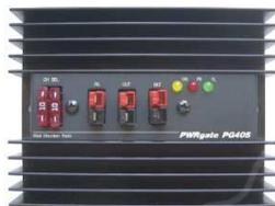
Es werden maximal 40A geschaltet. Dazu verwendet das PowerGate zwei 80A Schottky-Dioden, die die beiden Stromquellen voneinander isolieren. Durch den geringen, für diese Dioden typischen Spannungsabfall von 0.4V wird nur eine minimale Verlustleistung erzeugt. Eine einfache Ladeschaltung versorgt den Akku mit einer Erhaltungsladung, solange das Netzteil Strom liefert.
