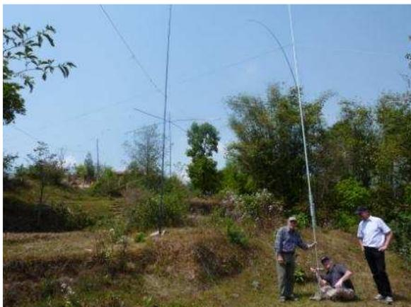
**Antennenpark: Triple Leg, Spiderbeam, HF2V für 40m und 160m-Inverted L**
