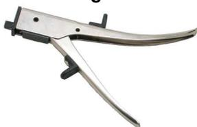
Dieses Werkzeug wird benötigt um viereckige Aussparungen für Powerpole-Einbaurahmen, Sicherungshalter, Gerätedisplays, etc. in ein Gehäuse oder ein Panel zu schneiden. Alles was dazu benötigt wird, ist ein 9,5 mm großes Startloch und ein wenig Muskelarbeit. Schneidet bis zu 1mm Alu oder 1,5mm Kunststoff
