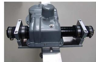
In den gespeisten Elementen sorgen je zwei Kontakte mit 10mm<sup>2</sup> Auflagefläche für guten Kontakt der Speiseleitung. So werden mit den Ultrabeam-Antennen auch große Leistungen bis 5kW PEP oder 3kW Dauerstrich möglich. Die EHUs sind aus ABS und mit einem UV- und wetterbeständigem Lack gestrichen. Gespeiste Elemente haben eine PL-Buchse, jede EHU hat eine wasserdichte Buchse für das 4-adrige Steuerkabel.
